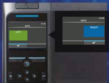
CL4 / 6NX Plus imprimen etiquetas y muestran instrucciones en la pantalla LCD para que los operadores clasifiquen (izquierda o derecha) las etiquetas impresas para su posterior procesamiento.
